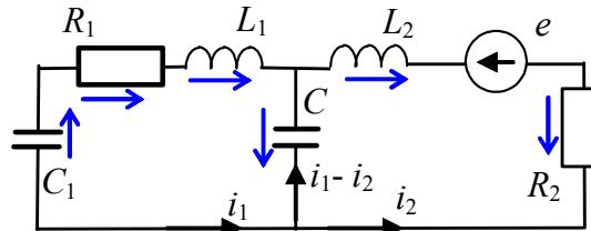
$$\begin{cases} 0 = L_1 \frac{di_1(t)}{dt} + R_1 i_1(t) + \int \frac{i_1(t) - i_2(t)}{C} dt + \int \frac{i_1(t)}{C_1} dt \\ e(t) = L_2 \frac{di_2(t)}{dt} + R_2 i_2(t) + \int \frac{i_2(t) - i_1(t)}{C} dt \end{cases}$$
