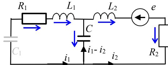
$$\begin{cases} 0 = L_1 \frac{di_1(t)}{dt} + R_1 i_1(t) + \int \frac{i_1(t) - i_2(t)}{C} dt \\ e(t) = L_2 \frac{di_2(t)}{dt} + R_2 i_2(t) + \int \frac{i_2(t) - i_1(t)}{C} dt \end{cases}$$
