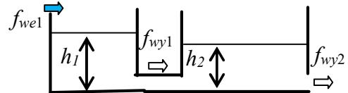
$$\begin{cases} A_1 \dot{h}_1(t) = f_{we}(t) - a_1(h_1(t) - h_2(t)) \\ A_2 \dot{h}_2(t) = a_1(h_1(t) - h_2(t)) - a_2 h_2(t) \end{cases}$$
