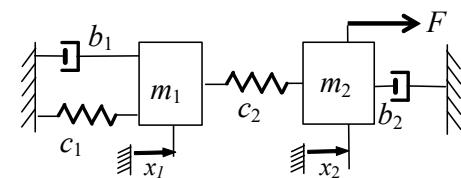
$$\begin{cases} F(t) = m_2 \ddot{x}_2(t) + b_2 \dot{x}_2(t) + c_2(x_2(t) - x_1(t)) \\ 0 = m_1 \ddot{x}_1(t) + b_1 \dot{x}_1(t) + c_1 x_1(t) + c_2(x_2(t) - x_1(t)) \end{cases}$$
