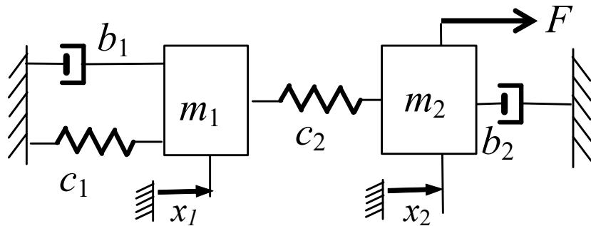
$$\begin{cases} F(t) = m_2 \ddot{x}_2(t) + b_2 \dot{x}_2(t) + c_2(x_2(t) - x_1(t)) \\ 0 = m_1 \ddot{x}_1(t) + b_1 \dot{x}_1(t) + c_1 x_1(t) + c_2(x_1(t) - x_2(t)) \end{cases}$$
