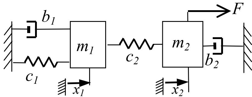
$$\begin{cases} F = m_2 \ddot{x}_2 + b_2 \dot{x}_2 + c_2(x_2 - x_1) \\ 0 = m_1 \ddot{x}_1 + b_1 \dot{x}_1 + c_1 x_1 + c_2(x_1 - x_2) \end{cases}$$
